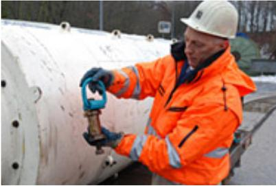
Michael Pauli präsentiert die Lösung: Mit speziellen Distanzhülsen lassen sich die Gewinde-Lastböcke sicher in die unterschiedlichen Rungenlöcher montieren.
