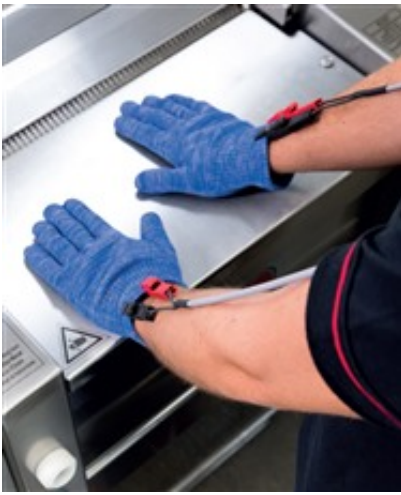
Schutzhandschuh mit Silberfäden mit der Steuerung der Maschine verbunden.
